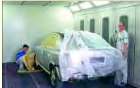
In der modernen Lackier- und Trocknungskabine wird das Fahrzeug nach dem Grundieren und Schleifen vor der Teillackierung abgeklebt.
